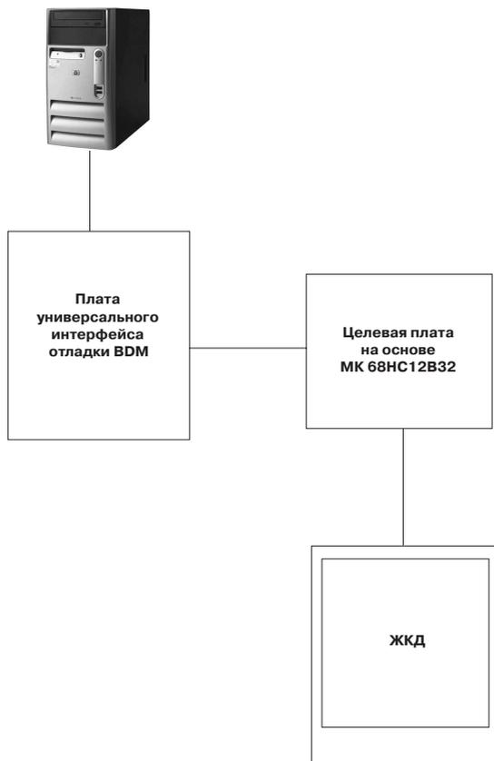
**Рис. 7.29.** Структура аппаратных средств системы защиты
