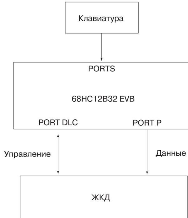
**Рис. 7.38.** Структура микропроцессорной системы для игры в «15»
