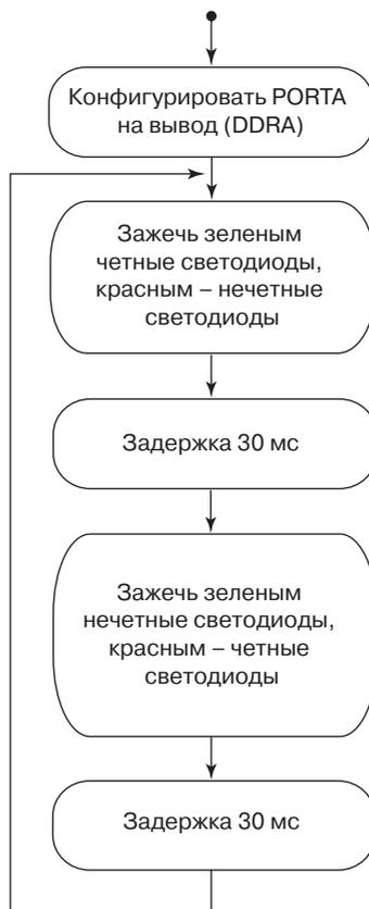
**Рис. 4.10.** Блок-схема алгоритма управления светодиодами
