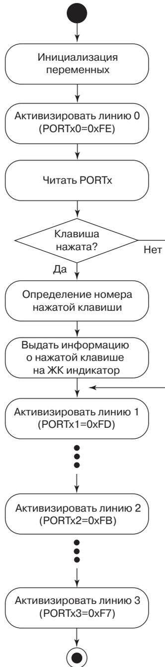
**Рис. 5.6.** Блок-схема алгоритма опроса матричной клавиатуры
