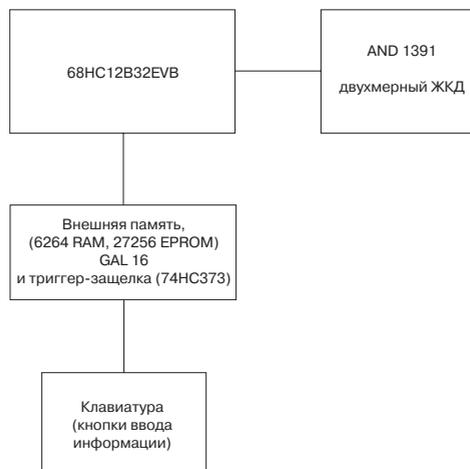
Рис. 7.37. Блок-диаграмма микропроцессорной системы для игры в «15»
