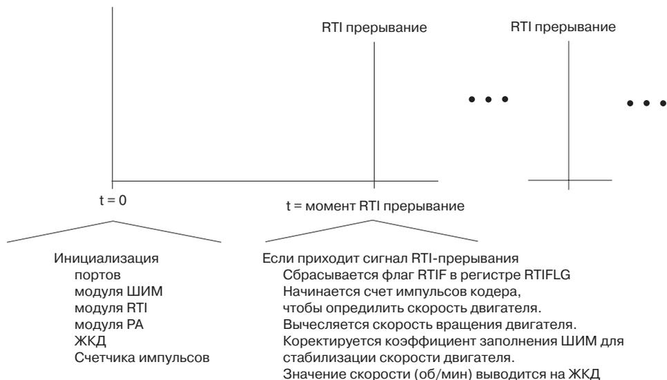
Рис. 7.16. Программа управления двигателем в режиме прерываний
