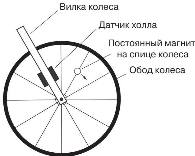
**Рис. 4.46.** Колесо велосипеда с датчиком Холла
