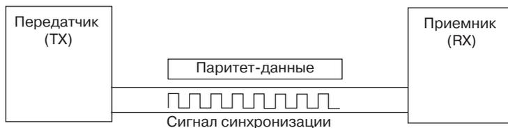
а) Последовательный периферийный интерфейс SPI
